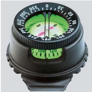
Le principe du compas magnétique est identique à celui de la boussole, mais l'aiguille magnétique est associée à une couronne graduée de 0 à 360° munie d'un flotteur. Cet ensemble, tournant sur un pivot, est appelé « équipage magnétique » et baigne dans un liquide composé d'eau et de glycol. Le boîtier antimagnétique est muni d'une fenêtre avec un trait de référence, ce qui permet une visée plus précise qu'avec une boussole ordinaire.
