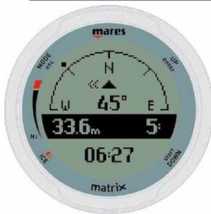
Ils utilisent des capteurs magnétiques extrêmement précis (type Fluxgate). On peut obtenir, dans notre contexte d'utilisation, une précision de l'ordre du degré et ils sont moins sensibles aux variations d'horizontalité. De nos jours ils sont de plus en plus intégrés dans les ordinateurs de plongée « haut de gamme ». Certains modèles permettent :
