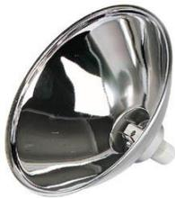
Le réflecteur est un miroir de forme parabolique qui permet de concentrer et réfléchir la lumière émise par « l'ampoule ». Celle-ci est placée en un point particulier, le « foyer ». La forme du réflecteur permet d'obtenir un faisceau étroit ou large (flood).
