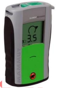
L'appareil émet ou détecte à chaque seconde un signal radio à 457 kHz. Ce signal est spécifique et mondial depuis 1986. Il traverse assez bien les milieux aqueux, mais est d'une portée limitée à environ 80 mètres. Son utilisation demande un peu d'entraînement. Il vaut mieux choisir un appareil simple, mais qui indique la direction et la distance du signal reçu.
