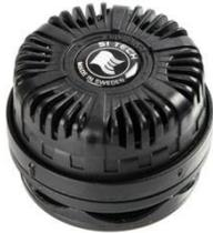
La soupape de purge permet, lors de la remontée, d'expurger l'air de la combinaison afin d'éviter une remontée trop rapide. C'est une soupape automatique, avec une possibilité de commande manuelle et dont le débit est ajustable. Elle est toujours placée sur une épaule de manière à pouvoir purger la combinaison dans n'importe quelle position.
