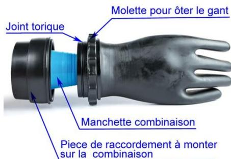
Nettement plus sophistiqué que les gants humides, l'isolation se fait par l'intermédiaire du gaz isolant venant de la combinaison étanche. Les sous-gants en Thinsulate est placé sous la manchette de la combinaison étanche, afin d'éviter le placage du gant lors de la descente. De cette manière une petite quantité de gaz isolant peut passer de la combinaison étanche vers le gant. L'étanchéité peut se réaliser caoutchouc sur caoutchouc ou à l'aide de pièces de raccordement sur la combinaison.
