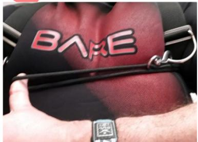
lors du passage d'une combinaison humide 3mm vers à une combinaison étanche en Néoprène compressé. Des élastiques trop ou pas assez tendus peuvent occasionner une mauvaise position des bouteilles qui seront trop en avant ou trop en arrière. Un test facile à réaliser consiste à tirer à fond sur l'élastique, il doit pouvoir être tiré jusqu'au sein situé à l'opposé de l'attache de l'élastique.
