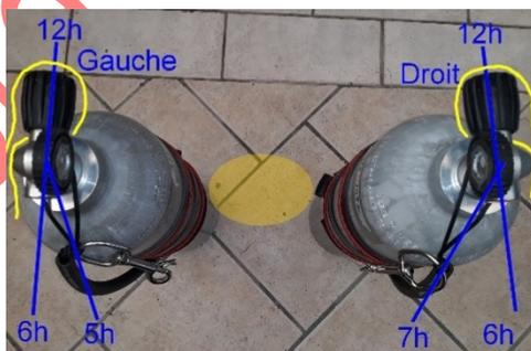
être orientés vers 5h pour la bouteille gauche et 7h pour la bouteille droite, afin d'assurer une position permettant une manipulation facile des volants.
