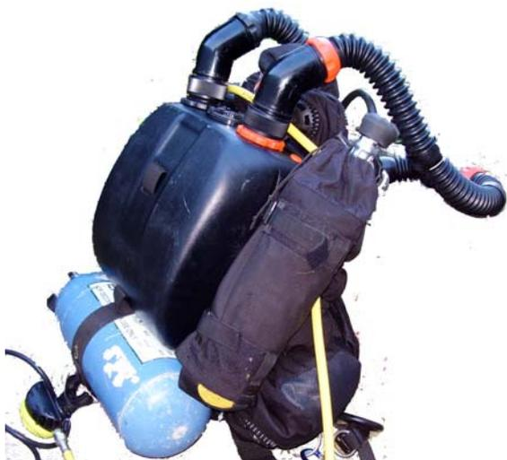
Recycleur SCR Dräger Dolphin équipé avec un bailout de 2lt à 300 bar, une double wing Dive System ( non standard) et de deux coudes à 135° Tecme (non standard) pour faire passer les tuyaux au dessus de la wing.
