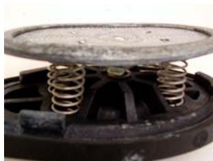
Il s'agit d'un grillage qui répartit le flux de gaz sur toute la surface de la chaux sodée. La section de passage des perforations est déterminée pour minimiser les pertes de charges.
