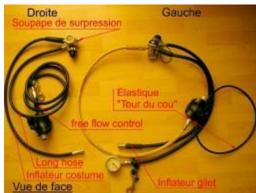
Figure 51 - Configuration des détendeurs
